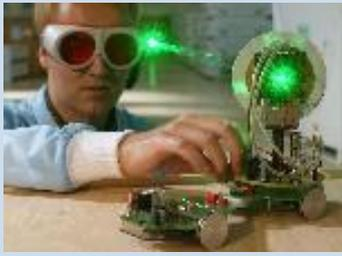
De la science-fiction à la réalité : l'énergie du faisceau laser est captée par les cellules photovoltaïques du rover et transformée en courant électrique qui alimente les moteurs du véhicule.
